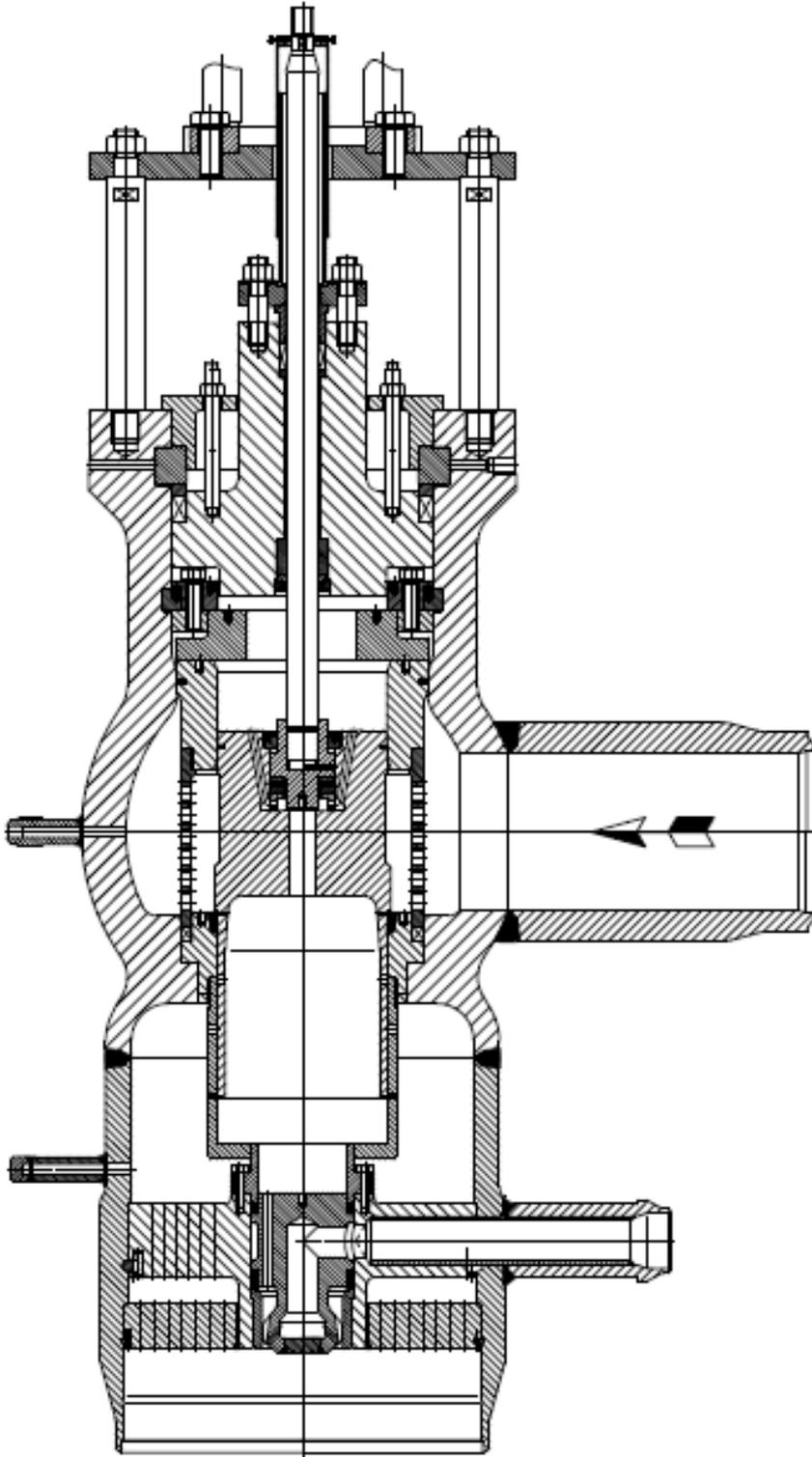
*Stoomomvormstation, kogelvormig gesmeed buis, zelfdichtende deksel constructie, klep ontlasting, pilot klep, instroomkorf, 2 traps geregeld, 2 smoorplaten, geïntegreerde stoomverstuiver,*
