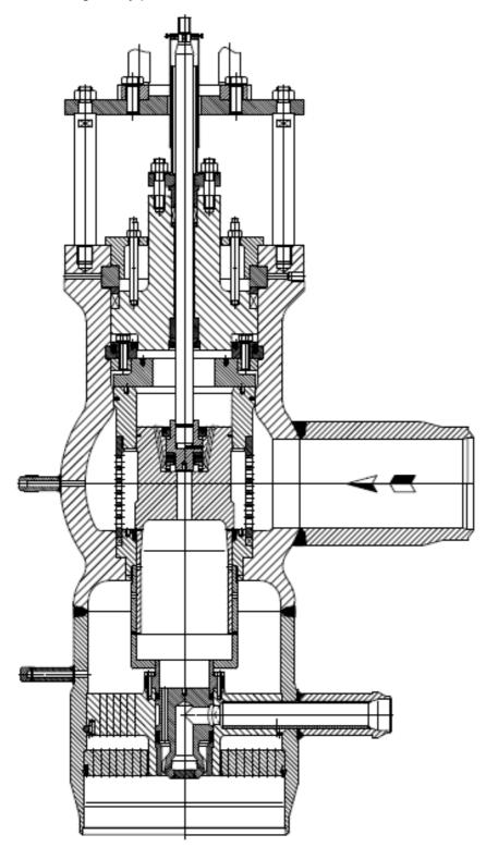
Stoomomvormstation, kogelvormig gesmeed buis, zelfdichtende deksel constructie, klep ontlasting, pilot klep, instroomkorf, 2 traps geregeld, 2 smoorplaten, geintegreerde stoomverstuiver,
